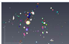
Visualisation 3D de la porosité dans un agglomérat
