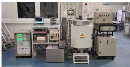
Réacteur en lit fixe traversé avec atmosphère contrôlée
