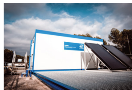
Test comparatif de performances de systèmes utilisant de l'énergie solaire réalisé avec deux chauffe-eaux solaires.
