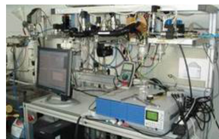
Banc multi-instrumenté pour tests de mono-cellule PEM
