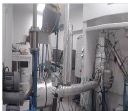
Pilote de traitement filtre à manche pour fumées industrielles
