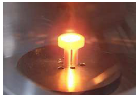
Émission de rayonnement à haute température d'une céramique
